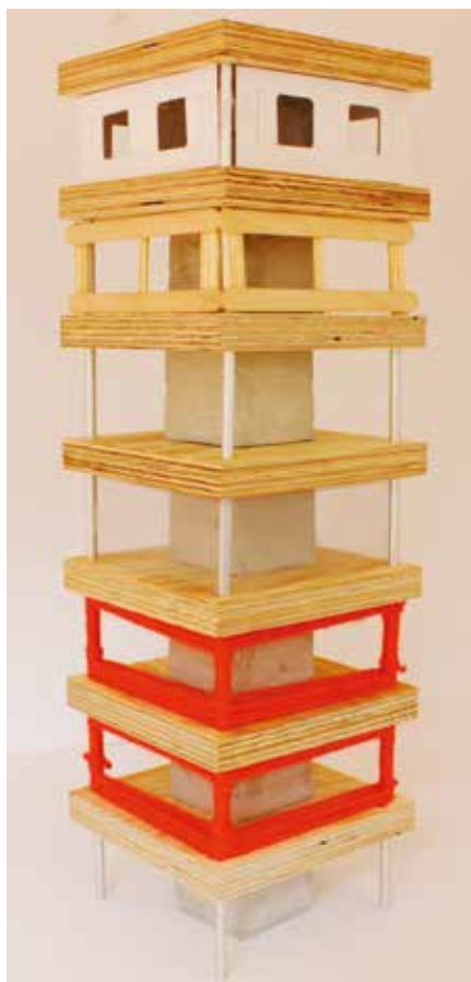
Aufbau eines Hochhauses. In der Mitte ist ein tragender Betonkern für das Treppenhaus. Die Etagen werden durch Stahlstützen getragen
